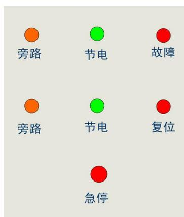
在空压机节电王的面板上有 3 个指示灯、3 个按钮、1 个急停按钮。
